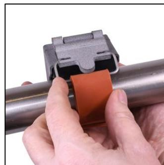
**Etapa 3:** puxe o mecanismo do came para prender firmemente o sensor de temperatura de abraçadeira HANI™ na tubulação.
